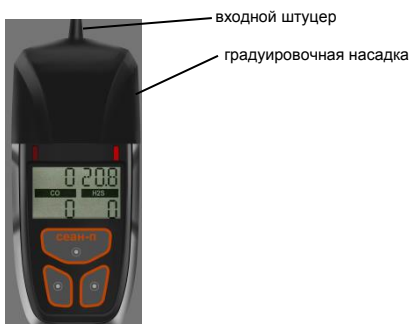
Рис. 3. Газоанализатор с градуировочной насадкой
